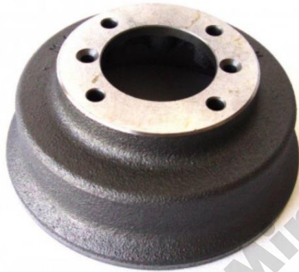
@MMCK Archiv_Patrick Stellwag_Trommelbremse hinten Cooper S versus Standard Mini
