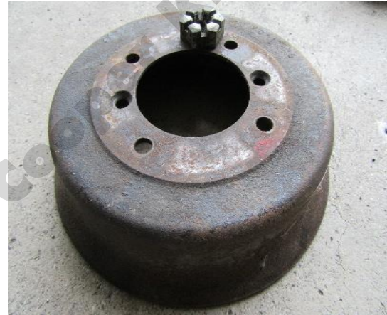
@MMCK Archiv_Patrick Stellwag_Trommelbremse hinten Cooper S versus Standard Mini
